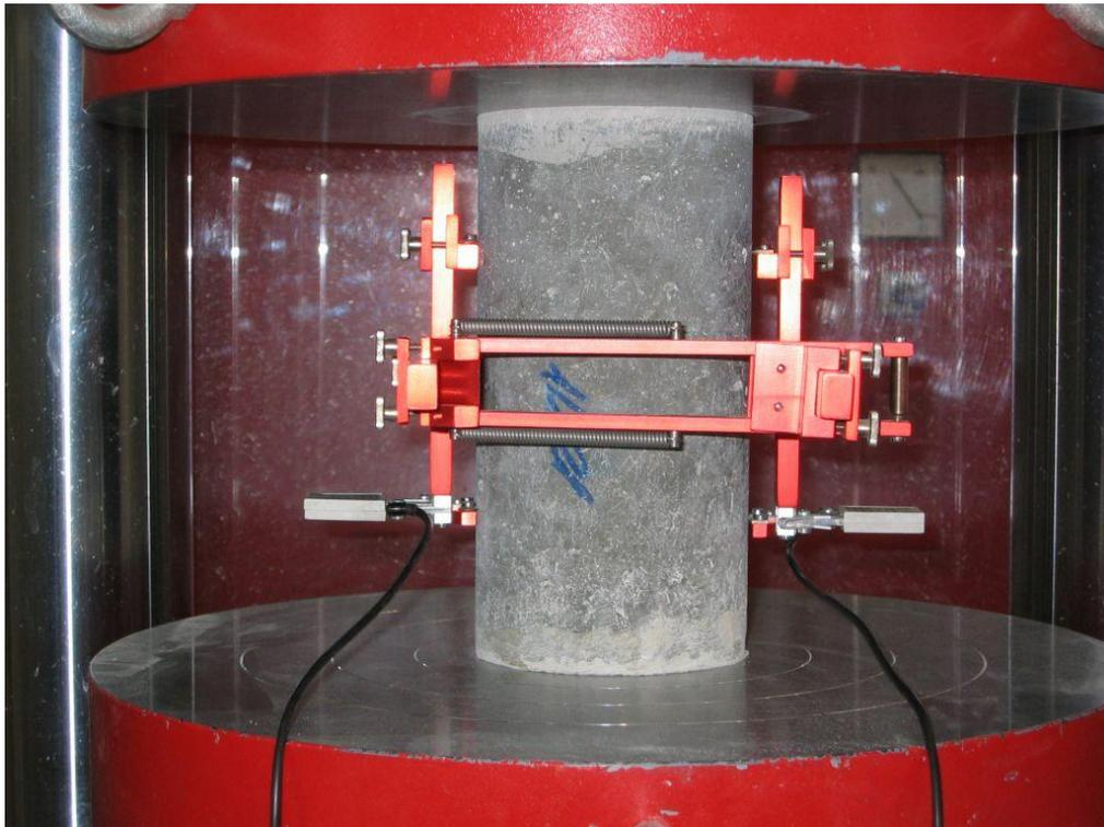
**Elektronischer Längendehnungsaufnehmer LD-DD1-2
